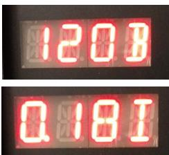
Ignitor test. Displays «IGNITOR» alternating with the current, followed by an «I» . Press «MODE».
