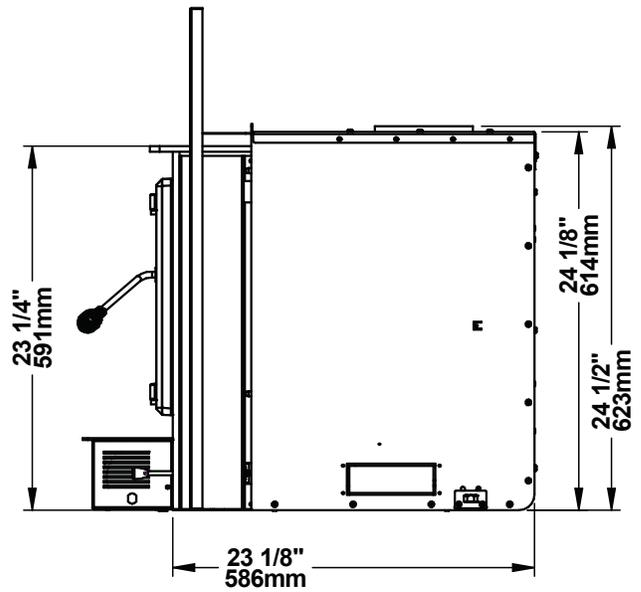
Figure 2 : Vue de côté - Projection maximum
