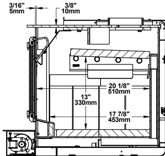
Figure 7 : Vue de côté - Chambre à combustion
