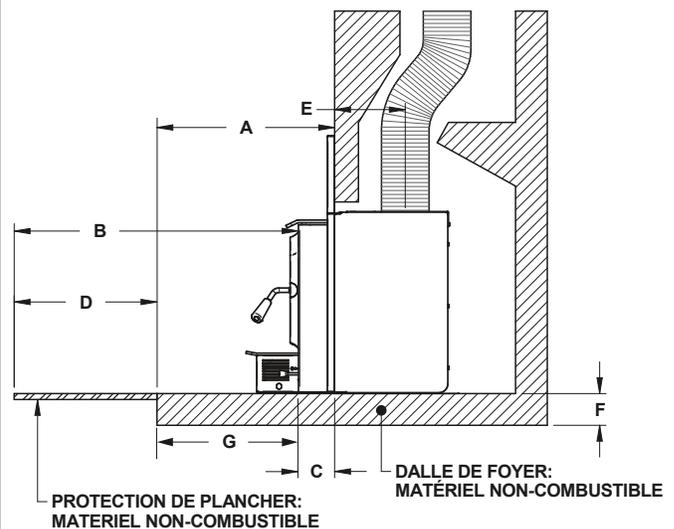
Protection de plancher additionnelle - Installation non surélevée
