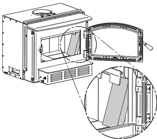
Figure 10 : Installer les briques de côté
