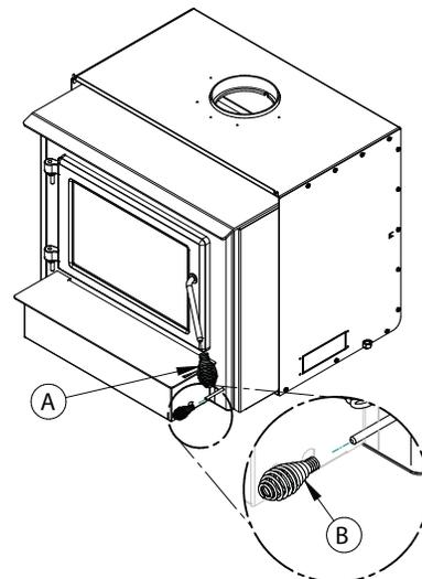
Figure 9 : Installer la poignée du contrôle d'air
