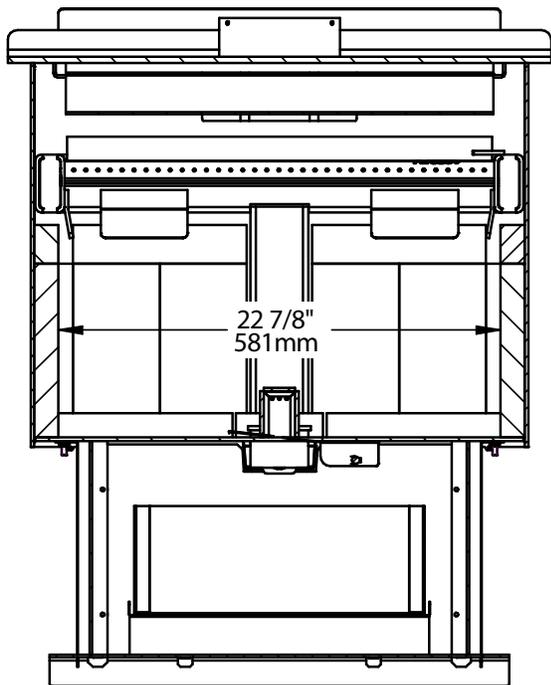
Figure 5: Vue de face - chambre à combustion
