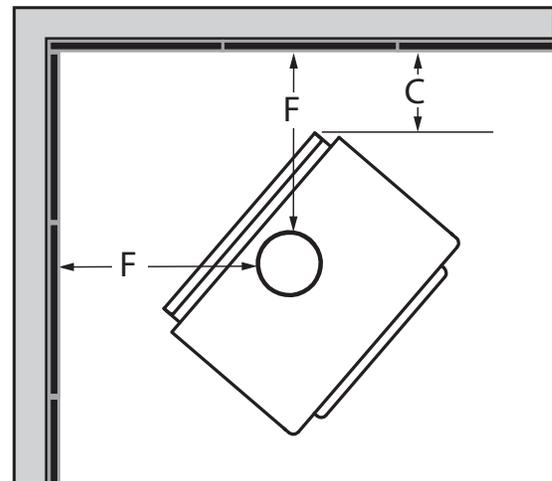
**Si la réduction de dégagement se trouve du même côté que la poignée de porte, positionner le poêle à minimum 6 po du mur latéral (dégagement B), autrement il peut être situé au dégagement indiqué dans le tableau ci-haut.**
