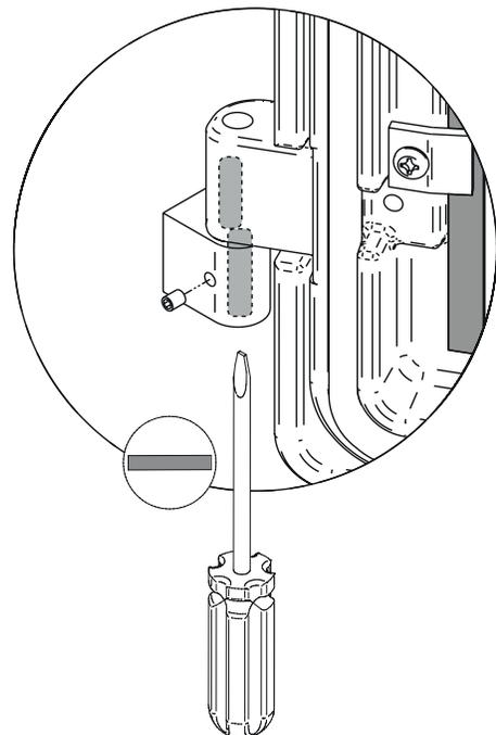
À l'aide d'un tournevis plat, tourner les tiges de pentures ajustables dans les sens indiqués pour ajuster les portes. Resserrez toutes les vis de pression sur les gonds de portes lorsque ces dernières sont aux positions désirées. Les configurations 1-2-3-4-5-6, indiquent dans quel direction celles-ci agissent sur l'ajustement de la porte.
