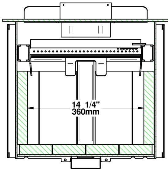
Figure 5: Vue de face - chambre à combustion
