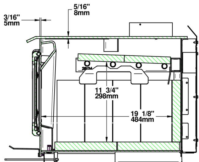
Figure 6: Vue de côté - chambre à combustion
