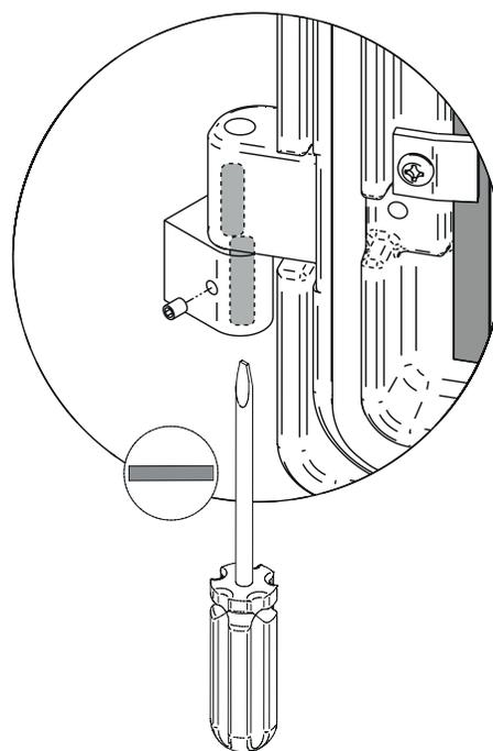
À l'aide d'un tournevis plat, tourner les tiges de pentures ajustables dans les sens indiqués pour ajuster les portes. Resserrer toutes les vis de pression sur les gonds de portes lorsque ces dernières sont aux positions désirées. Les configurations 1-2-3-4-5-6, indiquent dans quel direction celles-ci agissent sur l'ajustement de la porte.
