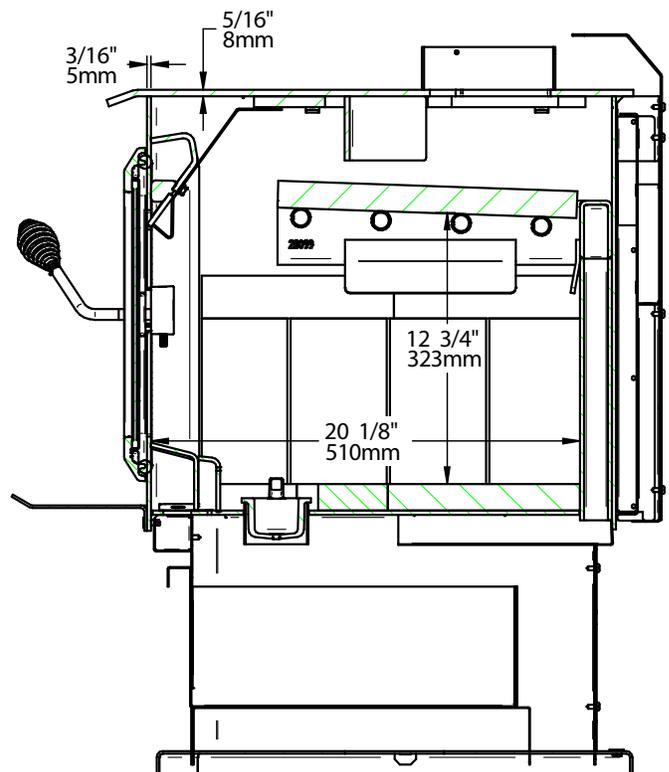
Figure 6: Vue de côté - chambre à combustion
