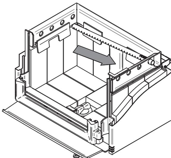
2. Aligner le chemin du tube et la dent dans le trou de la canalisation. Tenir le tube à l'aide d'une pince de serrage et suivre le mouvement décrit dans la figure ci-contre, pour le sécuriser en place. S'assurer que la dent touche le fond du chemin du tube.
