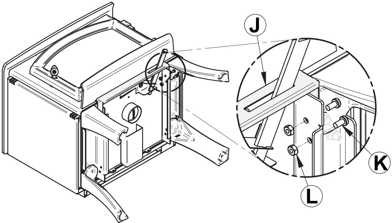
6. Mettre le poêle sur ses pattes et installer le tiroir à cendres. Remettre les briques réfractaires, le bouchon à cendre ainsi que la porte sur le poêle. (Voir étape 1)
