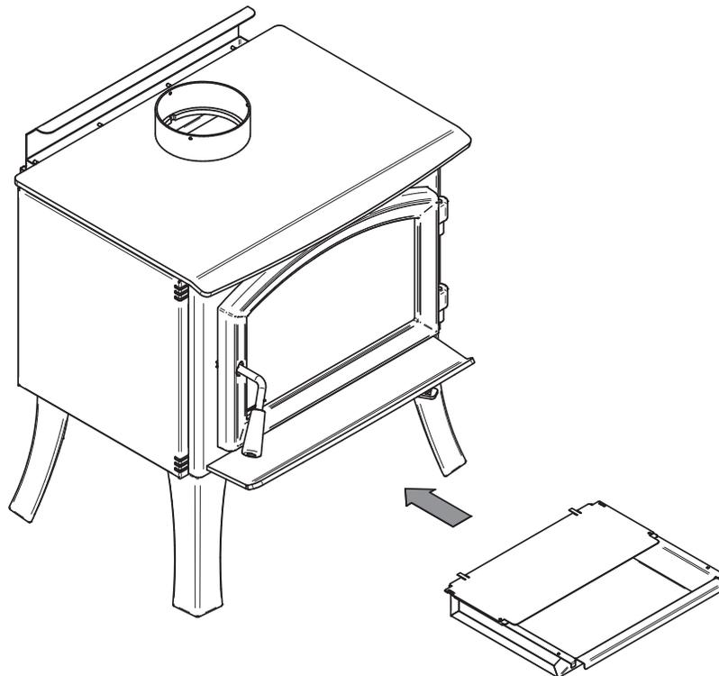
*Le coupe-feu, le bouchon à cendres si présent sur votre produit et les briques doivent être remis au bon endroit après le positionnement final de l'appareil.*
