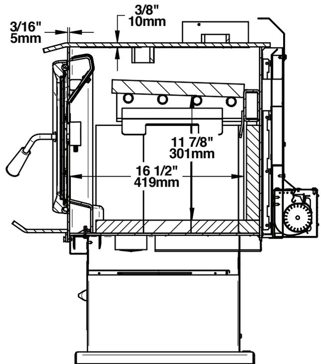
Figure 15: Vue de côté - chambre à combustion
