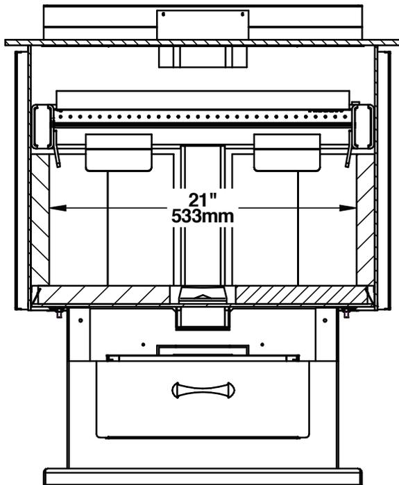
Figure 14: Vue de face - chambre à combustion
