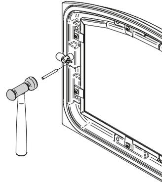
Figure 15: Installation de la goupille de retenue
