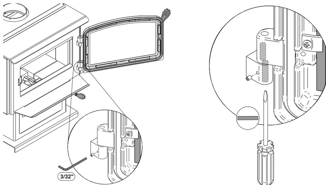
À l'aide d'un tournevis plat, tourner les tiges de pentures ajustables dans les sens indiqués pour ajuster les portes. Resserrez toutes les vis de pression sur les gonds de portes lorsque ces dernières sont aux positions désirées. Les configurations 1-2-3-4-5-6, indiquent dans quel direction celles-ci agissent sur l'ajustement de la porte
