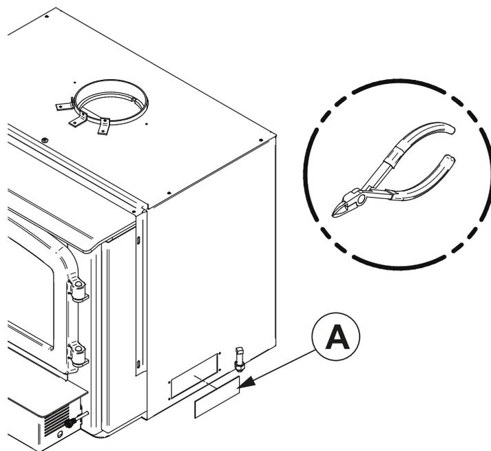
1. À l'aide de pinces, retirez la plaque métallique rectangulaire **(A)** retenue par les micro-joints afin de dégager l'ouverture prévue pour la prise d'air extérieur.
