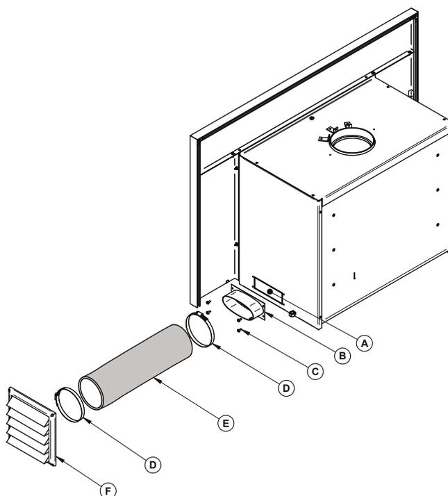
2. Installez l'adaptateur de prise d'air extérieur **(B)** à l'aide de 4 vis **(C)**. Fixez un tuyau flexible<sup>19</sup> **(E)** (non incluse) sur l'adaptateur **(B)** à l'aide d'un des collets ajustables **(D)**. Fixez l'autre extrémité au capuchon de prise d'air **(F)** à l'aide du deuxième collet ajustable **(D)**. Le capuchon de prise d'air **(F)** doit être installé à l'extérieur de votre habitation.
