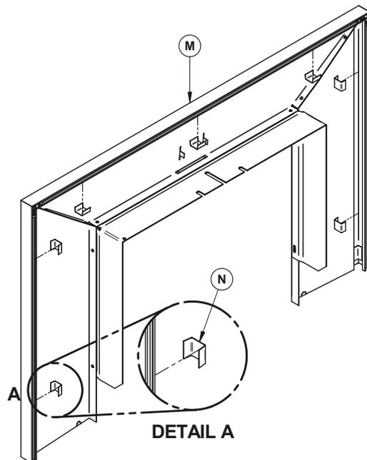
5. Aligner l'ensemble de moulures assemblées sur le bord gauche et droit de la façade et faites-le glisser lentement vers le bas le long de la façade.
