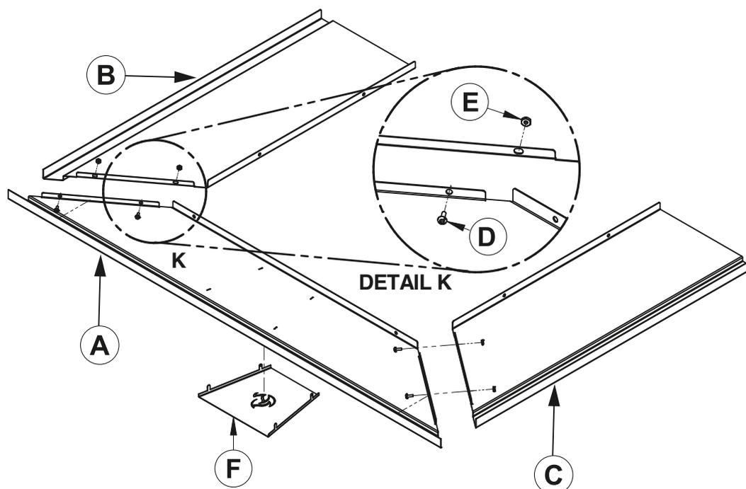
2. Déposer les panneaux avec les côtés avant des pièces sur une surface plane et non abrasive. Aligner les trous du panneau supérieur **(A)** avec les trous des panneaux latéraux **(B)** et **(C)**. Fixez-les en utilisant les quatre boulons **(D)** et écrous **(E)** fournis. Insérer la plaque **(F)** dans les fentes au centre du panneau supérieur **(A)**.
