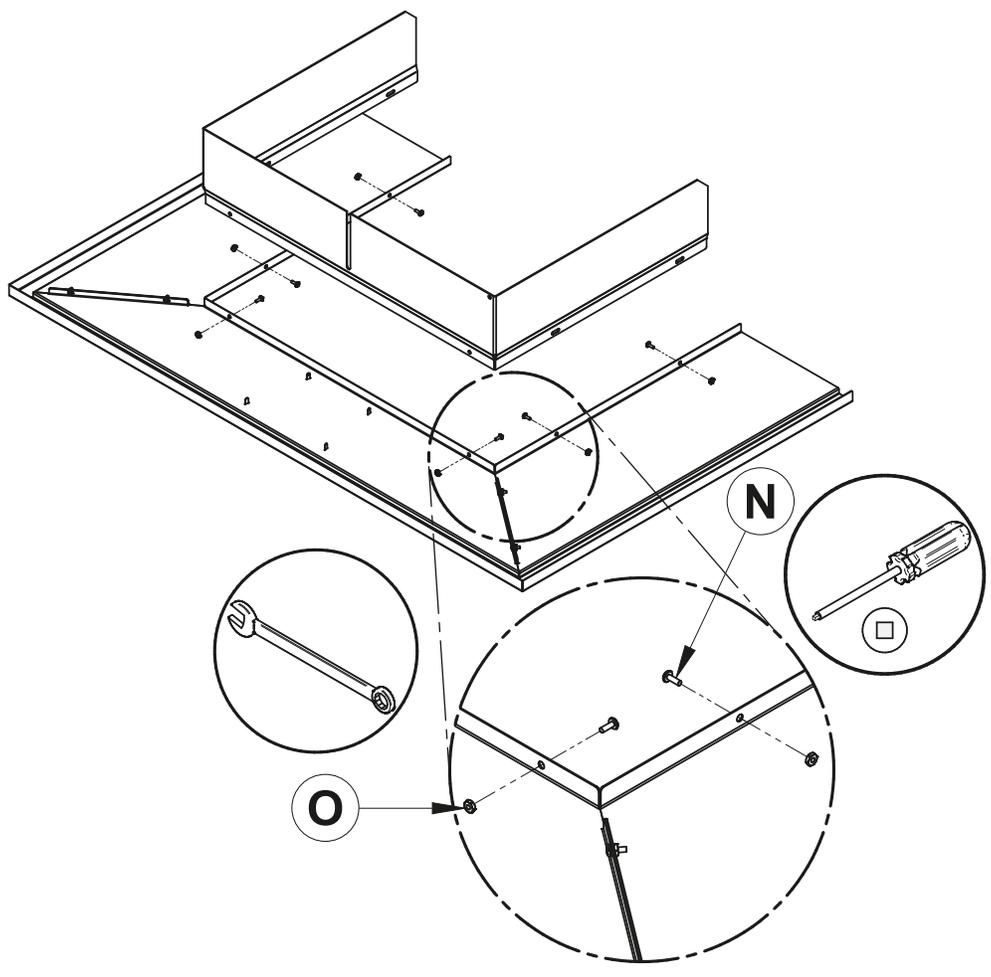
8. Fixez-les en utilisant les six boulons (**N**) et écrous (**O**) fournis.
