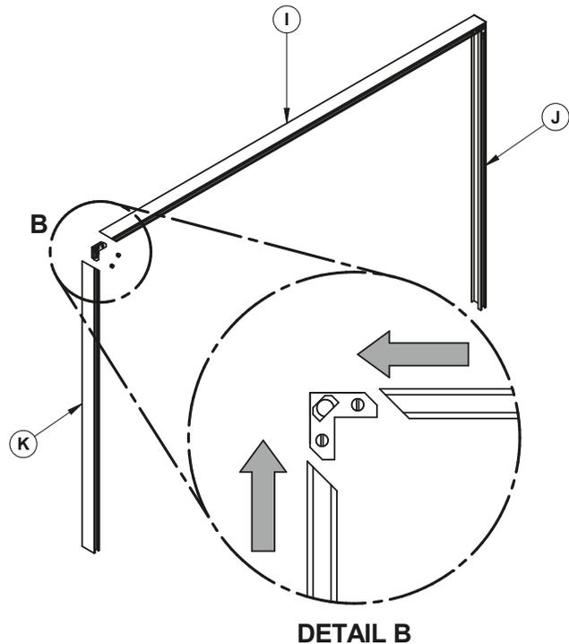
3. Visser partiellement les vis **(H)** sur l'équerre de moulure **(G)** puis superposer les équerres de moulure **(F)** et **(G)**.
