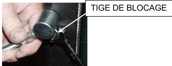
2. Pour augmenter la pression de la porte sur le cordon, tournez la poignée dans le sens inverse des aiguilles d'une montre; pour diminuer la pression de la porte sur le cordon, tournez la poignée dans le sens des aiguilles d'une montre.
