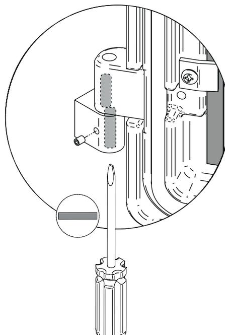
À l'aide d'un tournevis plat, tourner les tiges de pentures ajustables dans les sens indiqués pour ajuster les portes. Resserrez toutes les vis de pression sur les gonds de portes lorsque ces
