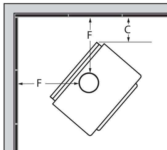
**Si la réduction de dégagement se trouve du même côté que la poignée de porte, positionner le poêle à minimum 6 po du mur latéral (dégagement B), autrement il peut être situé au dégagement indiqué dans le tableau ci-haut.**
