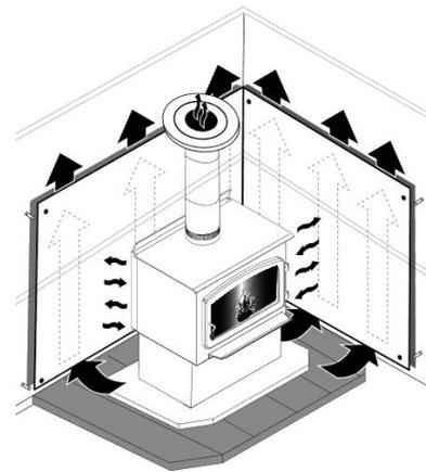
**Attention: pour réduire les dégagements d'un appareil utilisant un tuyau à paroi simple, l'utilisation d'un écran pare-chaaleur certifié avec le tuyau à paroi simple à 6" des matériaux combustibles doit être utilisé. Seulement dans ce cas, les mêmes dégagements qu'avec un tuyau double certifié peuvent être utilisés. Se référer au livret présent dans les options des écrans pour obtenir les dimensions à respecter.**
