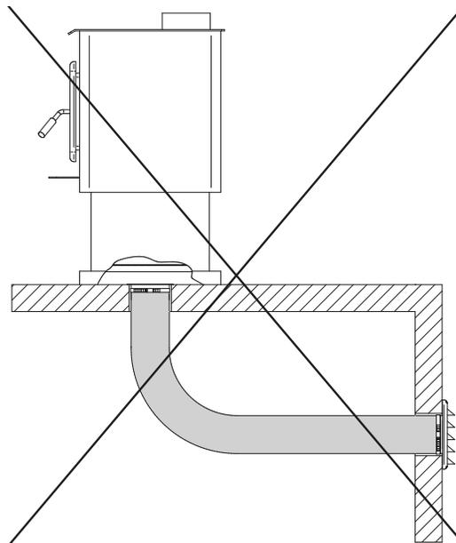
Ce poêle, approuvé maison mobile, requiert l'installation d'un ensemble d'entrée d'air frais **(A)** et d'un tuyau isolé flexible **(B)** de type HVAC (doit être conforme aux normes ULC S110 ou UL 181, classe 0 ou classe 1), vendu séparément. Voir le manuel d'installation de l'ensemble d'entrée d'air frais pour plus de détails.
