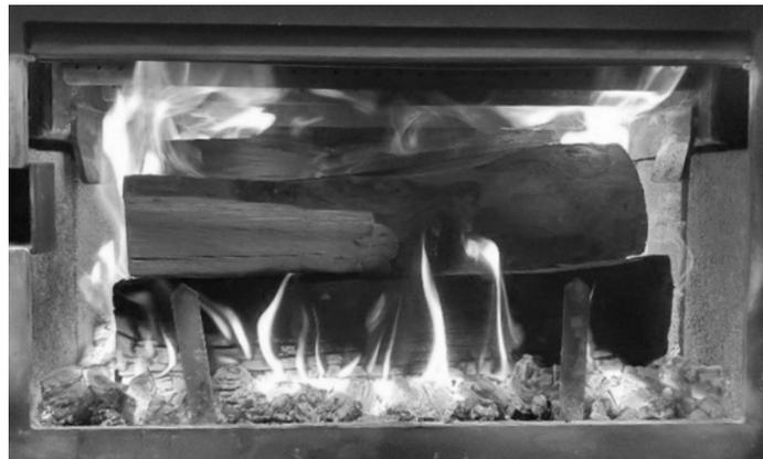
Fermer le contrôle d'air primaire par petits incréments (ex : 1/16 de pouce), de ½" à complètement fermé, entre 4 et 15 minutes après la période de chargement. Avant de fermer davantage, assurez-vous que l'intensité de la flamme augmente ou est stable. Fermer complètement la commande d'air. Allumer le ventilateur à la vitesse minimal after 30 minutes.
