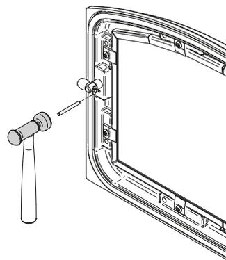
Figure 25: Installation de la goupille de retenue
