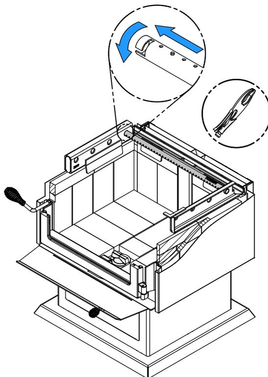
Prendre note que n'importe quel tube (B) peut être remplacé sans retirer le coupe-feu (A) et que les tubes sont tous identiques.
