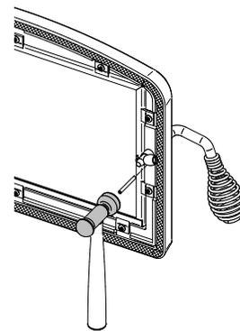
Figure 9: Installation de la goupille de retenue
