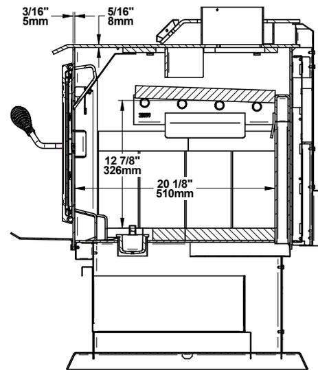
Figure 4: Chambre à combustion - Vue de côté
