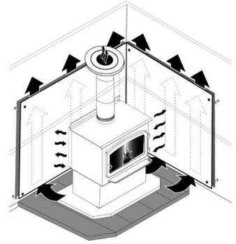
**Attention: Pour réduire les dégagements d'un appareil utilisant un tuyau à paroi simple, l'utilisation d'un écran pare-chaleur certifié avec le tuyau à paroi simple, à 6" des matériaux combustibles doit être utilisée. Seulement dans ce cas, les mêmes dégagements qu'avec un tuyau double certifié peuvent être utilisés.**
