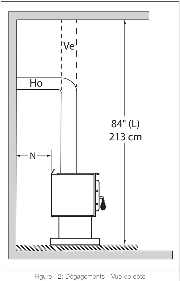
Figure 12: Dégradements - Vue de côté
