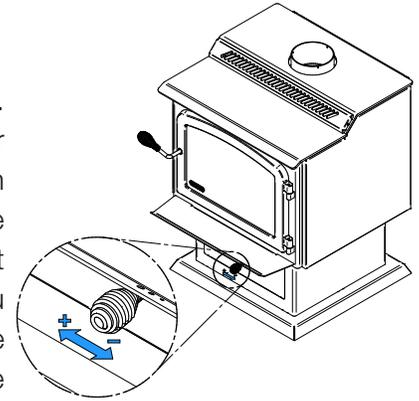
D'un autre côté, une trop grande admission d'air peut rendre le feu incontrôlable, créant des températures très élevées dans l'appareil ainsi que dans la cheminée et les endommager sérieusement. Une lueur rougeâtre sur l'appareil ainsi que sur les composants de la cheminée indique une surchauffe. Des températures excessives peuvent provoquer un feu de cheminée.
