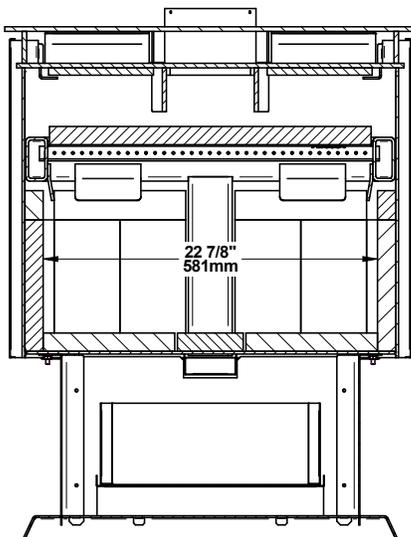
Figure 5: Chambre à combustion - Vue de face
