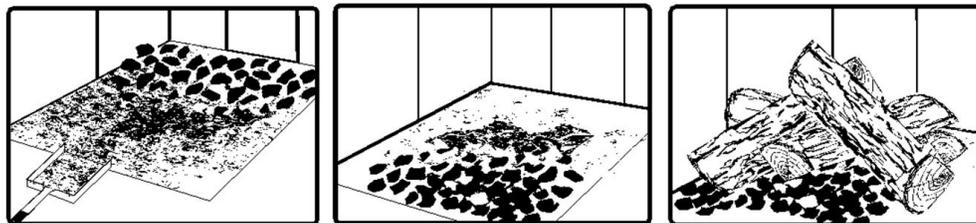
Le déplacement des braises est utile pour deux raisons. Tout d'abord, cela les rassemble près de l'endroit où la plus grande partie de l'air entre dans la chambre à combustion. Elles enflammeront donc la nouvelle charge rapidement. Deuxièmement, les braises ne seront pas étouffées par la nouvelle charge de bois. Lorsque les braises sont simplement étalées, la nouvelle charge brûle en amortissant longtemps avant de s'enflammer.
