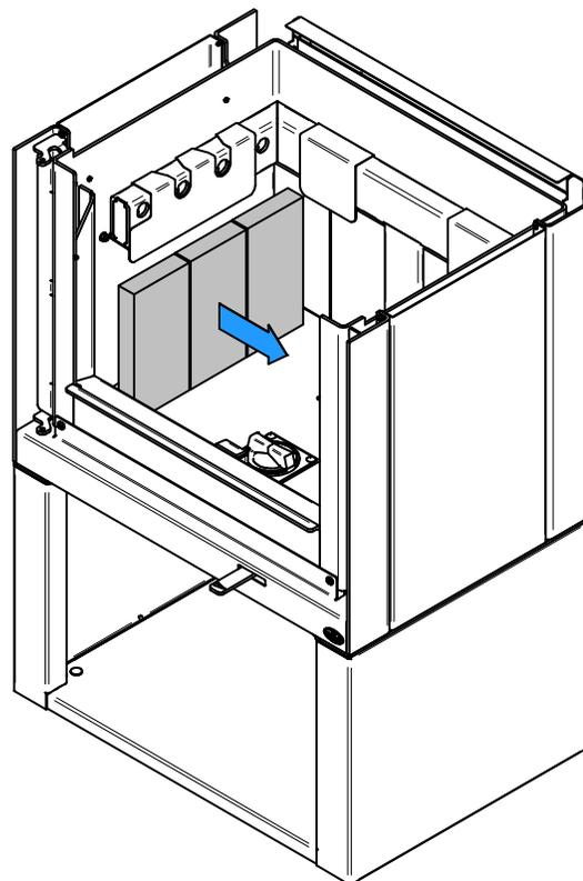
2. Retirer le reteneur de brique du côté gauche et faire glisser les pierres de côté pour les retirer.
