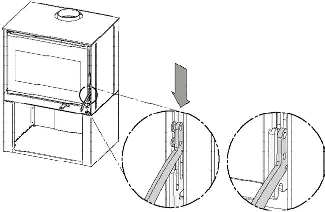
Figure 28: Ouverture à droite du poêle
