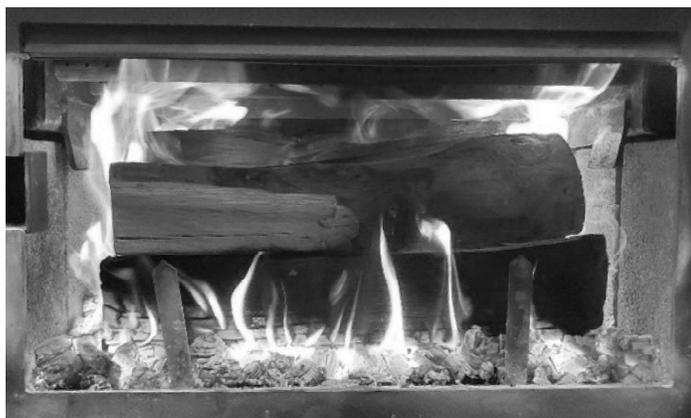
Fermer le contrôle d'air primaire par petits incréments (ex : 1/16 de pouce) jusqu'à atteindre le point médian de la position du contrôle d'air primaire, entre 4 et 15 minutes après la période de chargement. Avant de fermer davantage, assurez-vous que l'intensité de la flamme augmente ou est stable. Allumer le ventilateur à la vitesse maximale.
