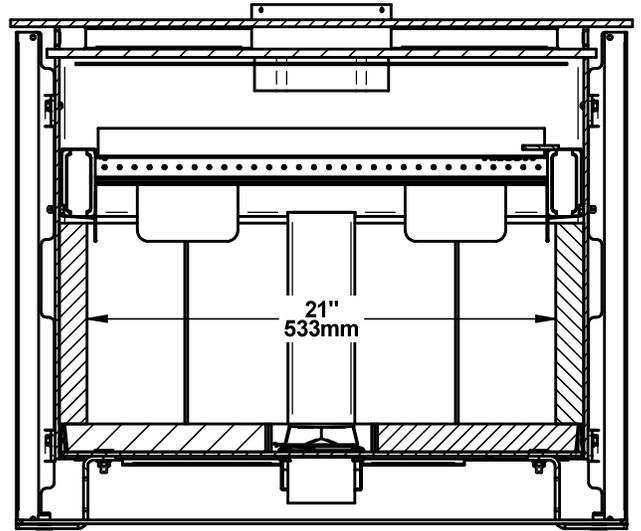
Figure 13: Vue de face de la chambre à combustion
