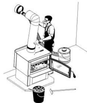
Le matériel le plus couramment utilisé comprend des tiges en fibre de verre munies de raccords filetés et de brosses en plastique. Une brosse est glissée de haut en bas de la cheminée pour en retirer la crésote par frottage.
