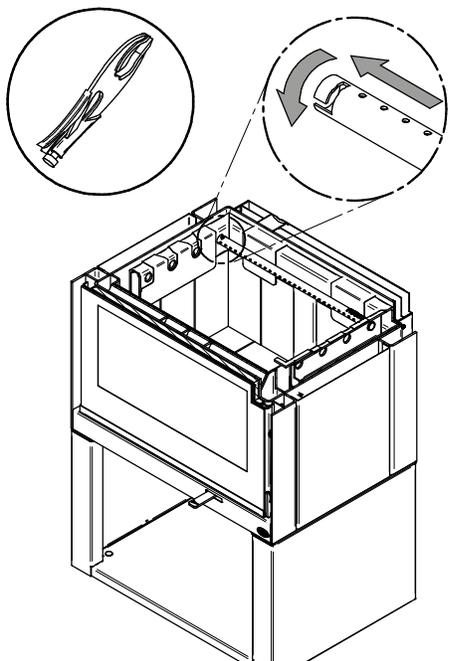
2. Alignez le chemin du tube et la dent dans le trou de la canalisation. Tenez le tube à l'aide d'une pince de serrage et suivez le mouvement décrit dans la figure ci-contre pour le sécuriser en place. S'assurer que la dent touche le fond du chemin du tube.
