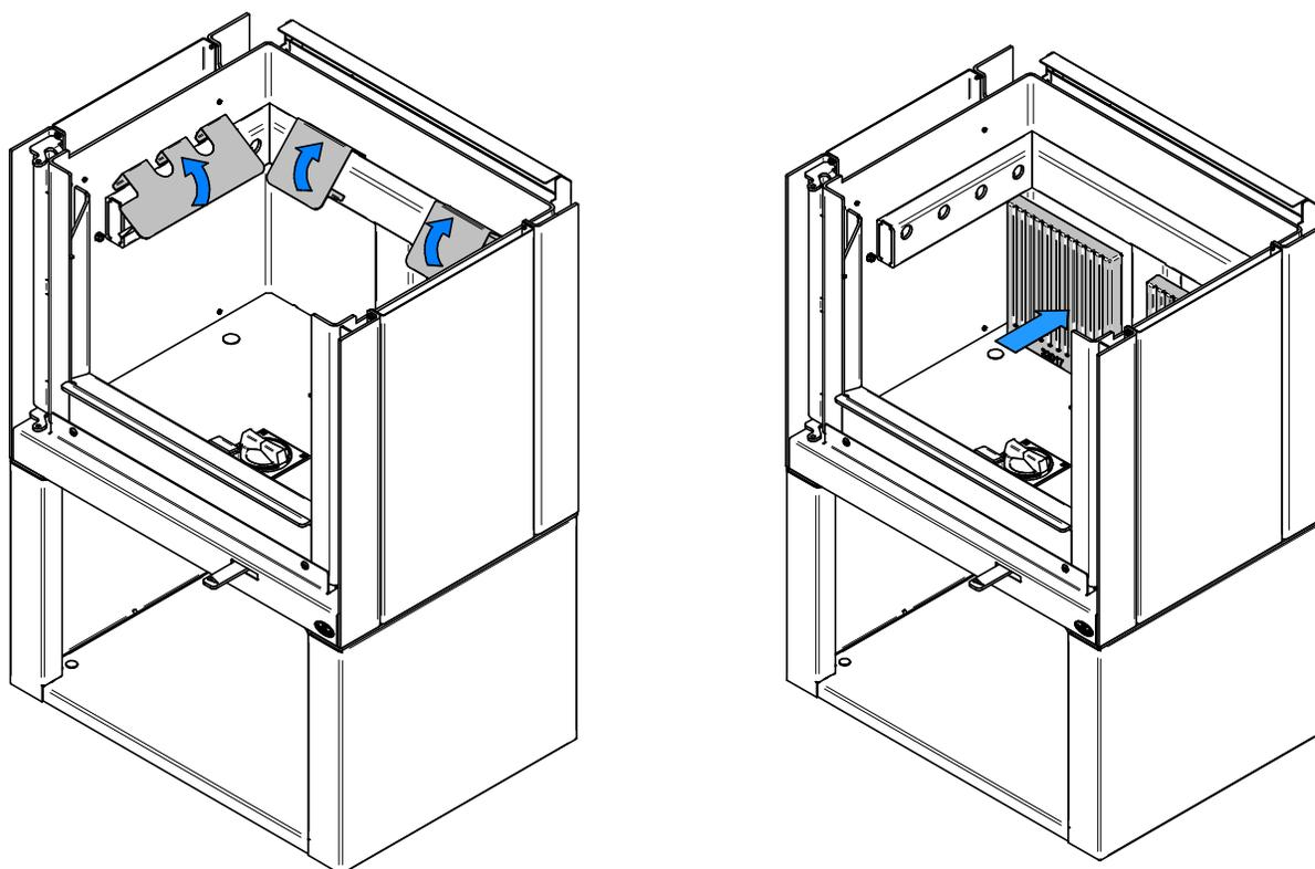
4. Retirer les reteneurs de briques et installer les pierres de dos (2). Les reteneurs ne pourront pas être réutilisés après avoir été retirés.
