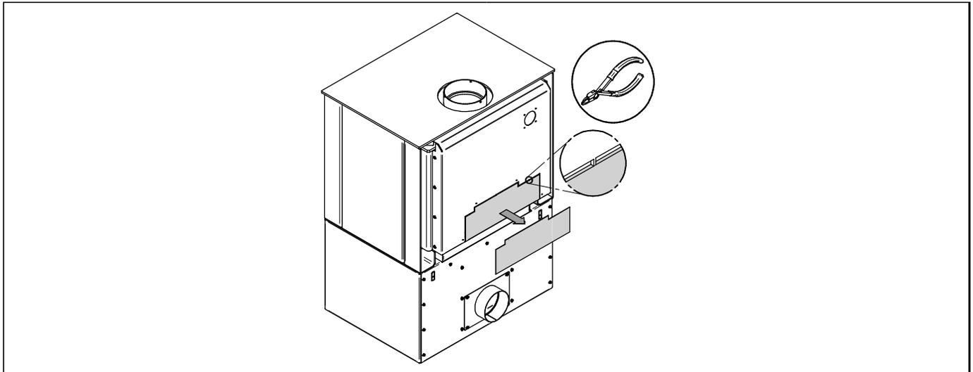
1. Retirer la plaque à l'arrière du poêle en coupant les microjoints avec des pinces.
