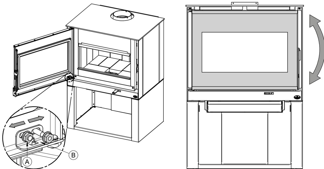
Figure 40: Ajustement de l'angle de la porte
