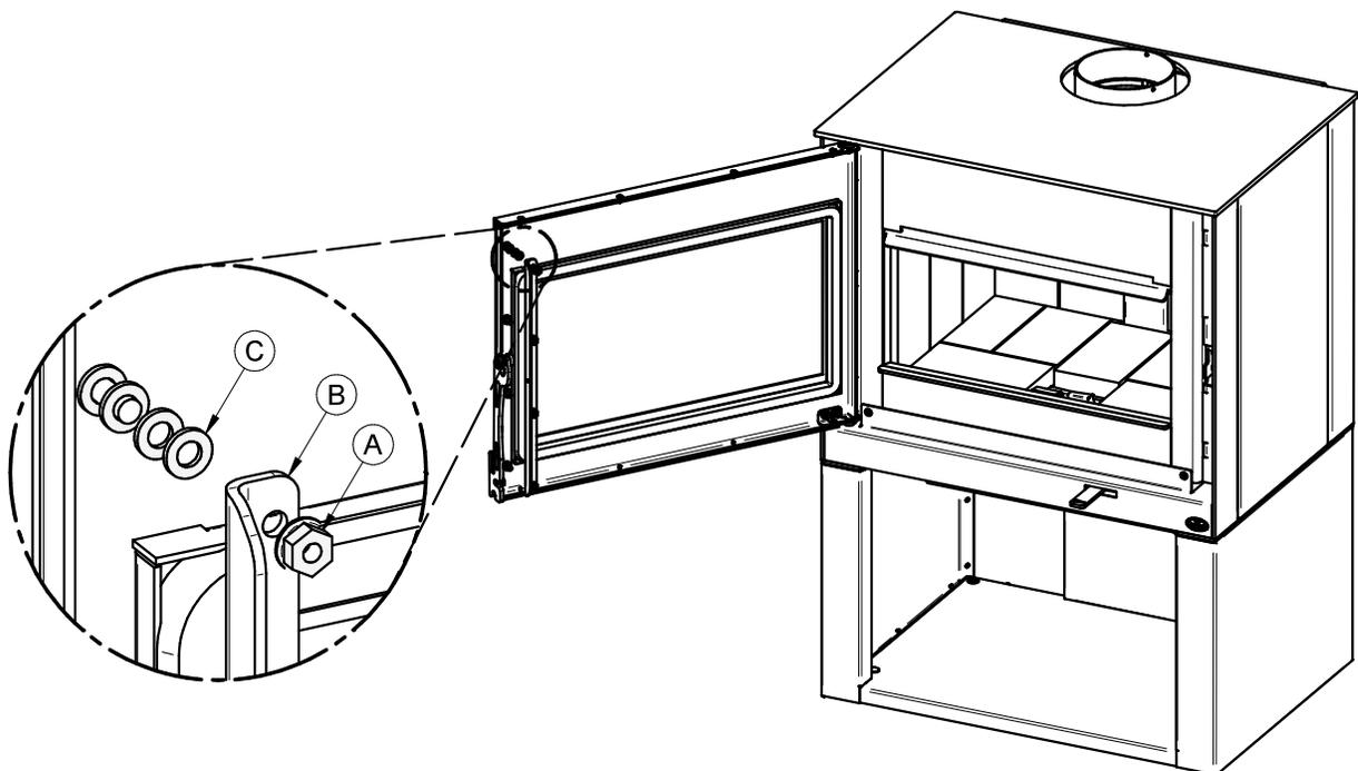
Figure 38: Ajustement de la porte avec l'équerre
