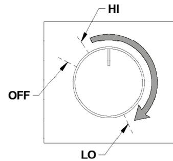
Figure 31: Rhéostat du ventilateur
