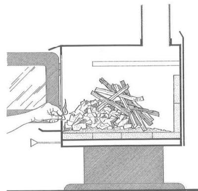
*Ne pas laisser le poêle sans surveillance lorsque la porte est légèrement ouverte. Toujours fermer et verrouiller la porte lorsque le feu est allumé.*
