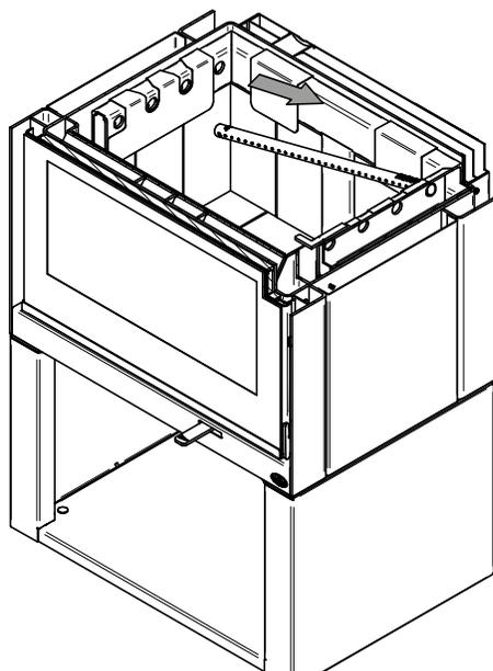
1. En commençant vers l'arrière, Inclinez et insérez le tube d'air secondaire arrière dans le trou du fond de la canalisation droite. Ensuite, levez et poussez le tube vers la gauche dans le trou correspondant de la canalisation de gauche.
