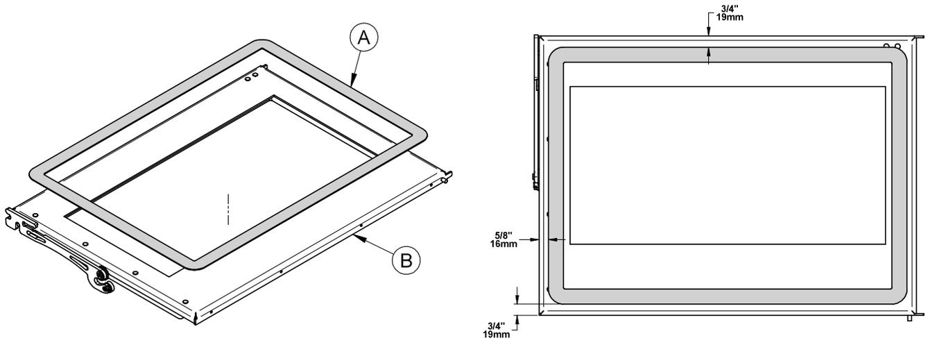
Figure 36: Remplacer le joint d'étanchéité de la vitre
