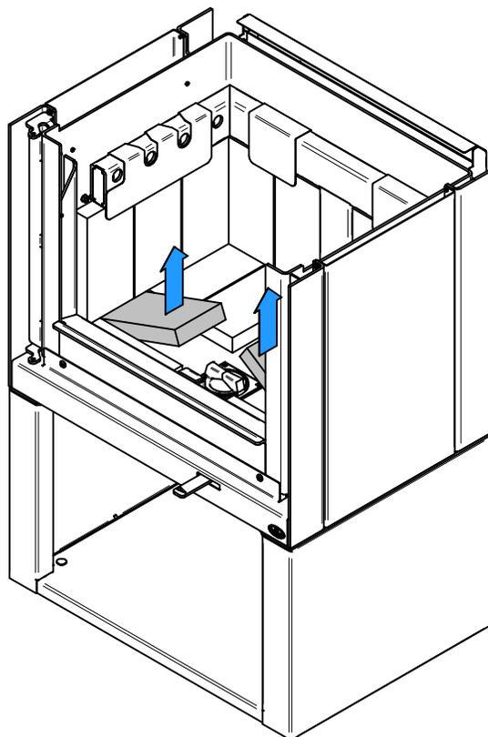
1. Retirer la brique de plancher du centre et ensuite retirer les six autres briques de plancher.
