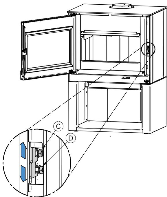
4. Dévisser les écrous **(D)** et soulever le mécanisme de verrouillage de la porte **(E)** afin d'augmenter la pression de la porte. Abaisser le mécanisme **(E)** pour réduire la pression.
