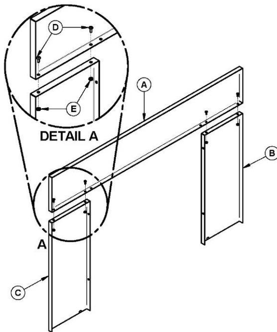
Alignez les trous du panneau supérieur (A) avec les trous des panneaux latéraux (B) et (C). Fixez-les en utilisant quatre (4) boulons (D) et écrous (E) fournis (voir **DETAIL A.**)
