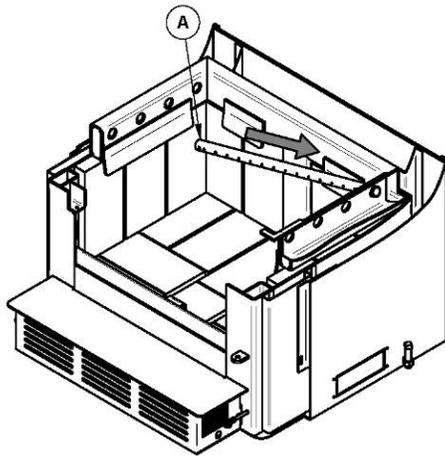
1. En commençant vers l'arrière, inclinez et insérez le tube d'air secondaire (A) arrière dans le trou du fond de la canalisation droite. Ensuite, levez et poussez le tube vers la gauche dans le trou correspondant de la canalisation de gauche.
