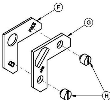
Vissez partiellement les vis (H) sur l'équerre de moulure (G) puis superposez les équerres de moulure (F) et (G) comme dans l'image de gauche.
