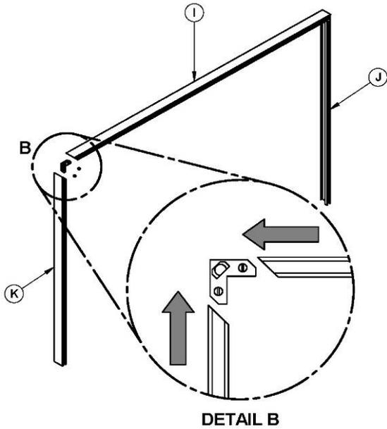
Insérez les équerres (F) et (G) superposé avec les vis (H) dans les rainures de chaque moulure décorative (I), (J) et (K) (voir **DETAIL B**). Alignez les coins du côté à angle de chaque moulure, puis serrez les vis (H) pour sécuriser l'ensemble de moulures.
