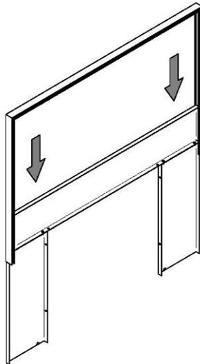
Alignez l'ensemble de moulures assemblées sur le bord gauche et droit de la façade et faites-le glisser lentement vers le bas le long de la façade.
