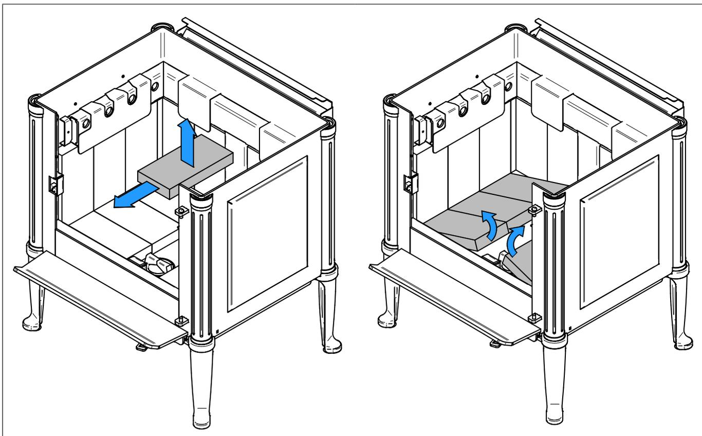
1. Retirer la brique de plancher du centre et ensuite retirer les six autres briques de plancher.
