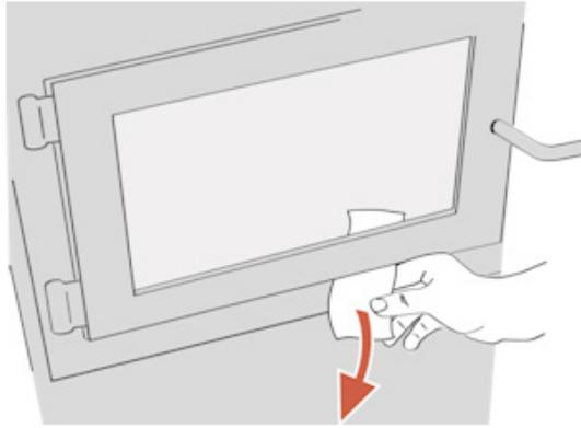
Figure 24: Vérification du joint de la porte
