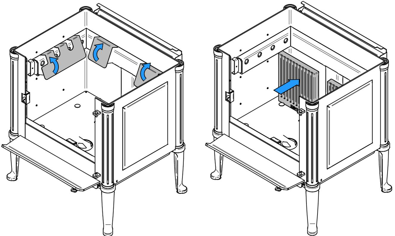
4. Retirer les reteneurs de briques et installer les pierres de dos (2). Les reteneurs ne pourront pas être réutilisés après avoir été retirés.
