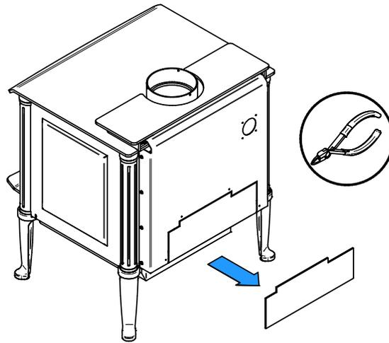
1. Retirer la plaque à l'arrière du poêle en coupant les microjoints avec des pinces.
