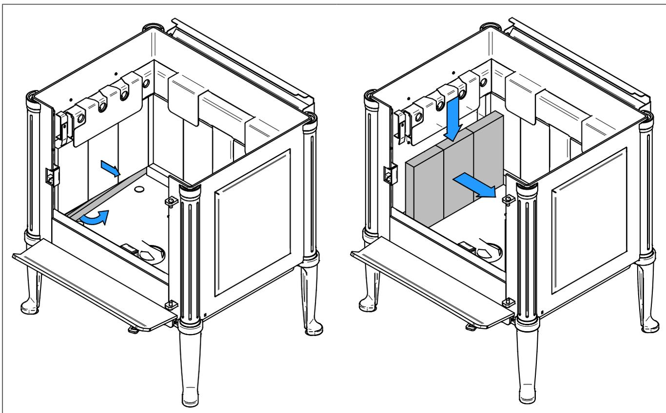
2. Retirer le reteneur de brique du côté gauche et faire glisser les pierres de côté pour les retirer.
