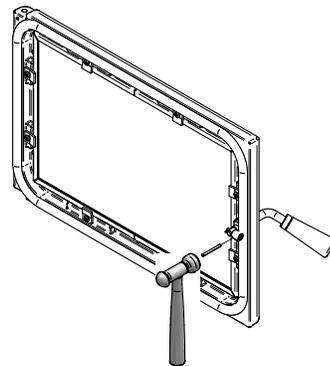
Figure 23: Installation de la goupille de retenue
