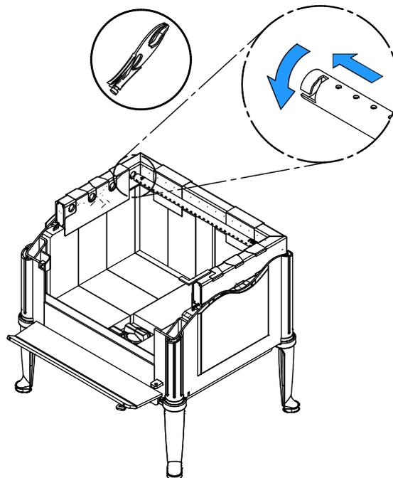
2. Alignez le chemin du tube et la dent dans le trou de la canalisation. Tenez le tube à l'aide d'une pince de serrage et suivez le mouvement décrit dans la figure ci-contre pour le sécuriser en place. S'assurer que la dent touche le fond du chemin du tube.
