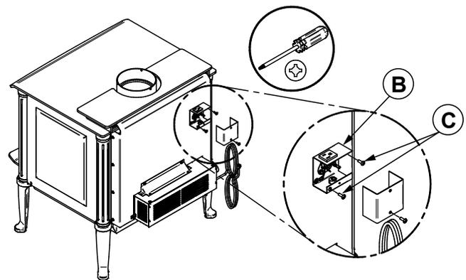
2. Visser le ventilateur (E) en place en utilisant les vis (D) incluses dans le feuillet d'installation. Visser le thermodisque (B) avec les vis (C) fournies avec le thermodisque à l'arrière du poêle. **Le cordon électrique du ventilateur ne doit pas toucher à aucune surface du poêle de façon à éviter les décharges électriques ou les incendies. Le cordon électrique ne doit pas passer sous le poêle.**
