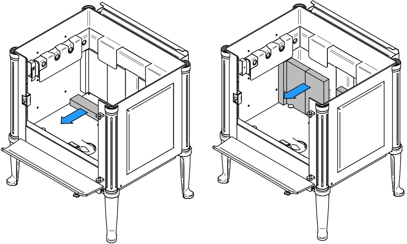
3. Retirer les briques du bas (2), dans le dos et faire glisser les briques de dos (6) pour les retirer.
