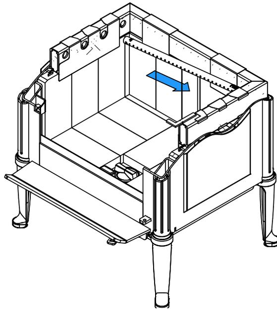
1. En commençant vers l'arrière, inclinez et insérez le tube d'air secondaire arrière dans le trou du fond de la canalisation droite. Ensuite, levez et poussez le tube vers la gauche dans le trou correspondant de la canalisation de gauche.
