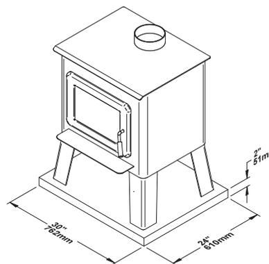
Figure 30: Protection de plancher pour maison mobile
