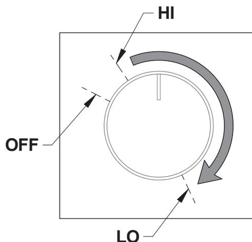
Figure 20: Rhéostat du ventilateur
